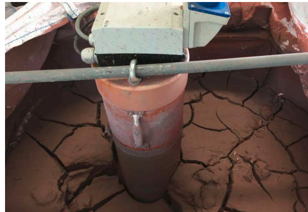
Bild 3: Anwendung des Filtrationsbeschleunigers Quickdrain (DPMA) zur kommunalen Klärschlamm entwässerung (Big Bag)
